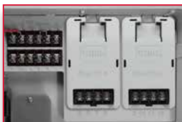
Configuration 12 voies avec 2 modules de 4 voies
