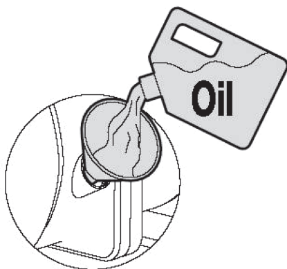
6- Rajouter de l'huile propre jusqu'au niveau requis. Consulter les caractéristiques techniques au besoin.
