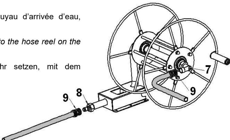
7. Mettez en place le raccord rapide (9) sur le tuyau d'arrosage, connectez-le au dévidoir.
