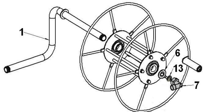
3. Positionnez la rondelle (6), le joint (13), puis le raccord tournant de sortie d'eau ¾" (7). Serrez avec une pince.
