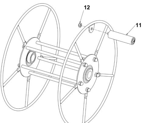
2. Insérez le tube (1) dans le moyeu du tambour.
