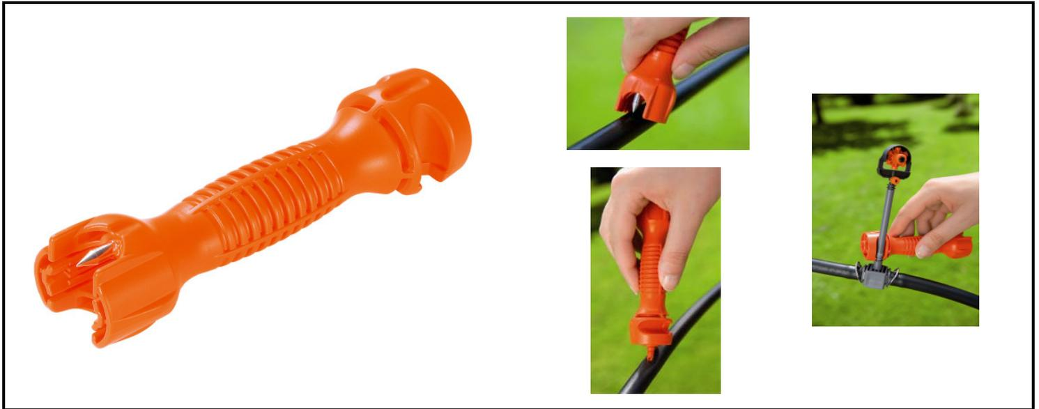
**Clé multi-fonctions** : pour percer le tuyau (à l'aide du poinçon métallique), insérer les goutteurs auto-régulants et régulateurs de pression, monter les tubes prolongateurs pour micro-asperseurs et les jonctions droites 4,6 mm.
